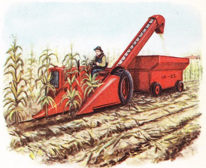
Une faucheuse mécanique au travail dans un champ de maïs: la puissante machine coupe le plant, dépouille l'épi, et l'égrène presque en même temps.
